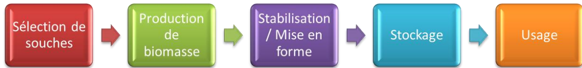
Figure 25. Schéma des principales étapes liées à l'utilisation industrielle de micro-organismes d'intérêt.
