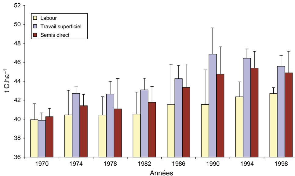
**Fig. 2.** Evolution des stocks de carbone du sol au cours du temps selon le mode de travail du sol sur l'essai longue durée de Boigneville ( $t C \cdot ha^{-1}$ , sur la base d'une masse de terre de  $3900 t \cdot ha^{-1}$ ). Les barres d'erreur indiquent les valeurs d'écart type pour les données relatives à la rotation maïs-blé.
